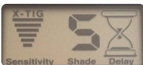
LCD interne indiquant le niveau d'assombrissement, temps de réaction, délai, mode meulage et mode "TIG"
