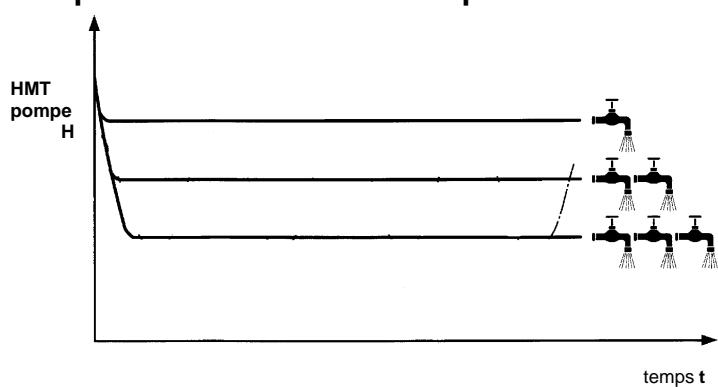
Contrairement aux groupes de distribution d'eau avec réservoir de restitution, les pompes avec automate de commande Controlmatic E.2 se caractérisent par une pression constante dans le temps quel que soit le débit.
