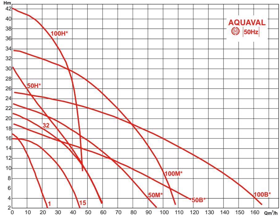
\* Caractéristiques hydrauliques obtenues par changement de roue à basse (B), moyenne (M) ou haute (H) pression : la roue est interchangeable entre les types d'une même gamme.
