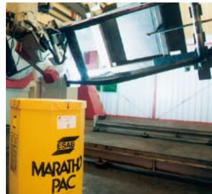
Production robotisée de structures d'engins de terrassement.
