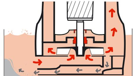
Le Système SAN peut être désactivé. La courbe de la pompe gagne ainsi 1 mètre de colonne d'eau de pression supplémentaire à débit équivalent.
