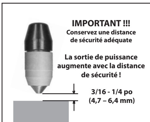
Figure 4-3. Distance de sécurité par rapport à la sortie de puissance
